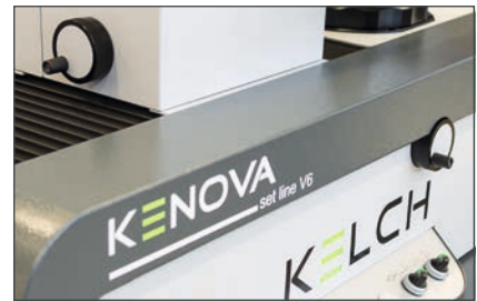
Feinverstellung in beiden Achsen
